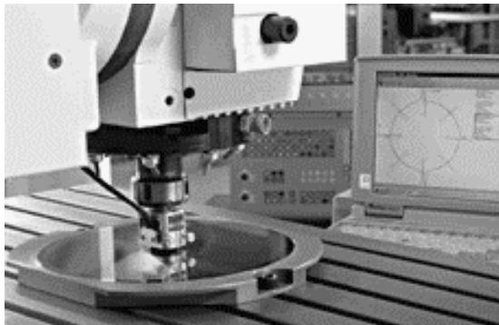
Rys.7. Pomiar siatką optyczną
